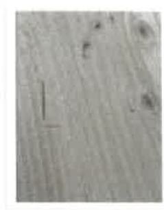
3. Pente de fil : Par rapport à l'axe longitudinal du sciage de la pièce (%)
